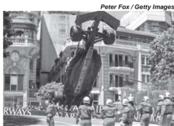
Detalhe da prancha acoplada ao fundo do carro como medidor da altura em relação ao solo
