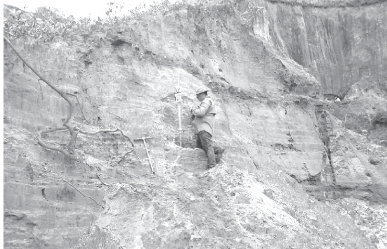
O novo permeâmetro avalia a condutividade hidráulica do solo, ou seja, mede a capacidade da água fluir dentro do solo, por meio de recursos digitais e um microcomputador de baixo custo
